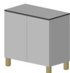
(Trar0066) MÓDULO DE ALMACENAJE 550x300 y 563 de alto con puertas y balda interior realizado en chapa de acero de 0,8 mm de espesor pintada al horno con pintura Epoxy-Poliéster blanca, patas de madera y tapa de compacto de 12 mm.
